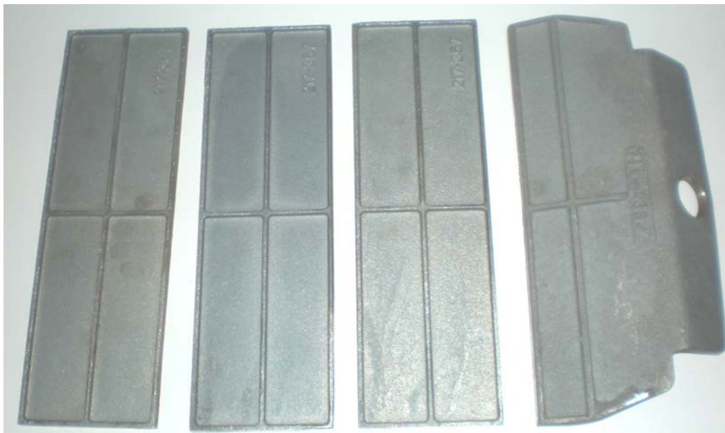
Фигура 1.4.6. Подредба на направляващите чугунени плочи, които формират ходовете на димните газове в горивната камера на котела;
