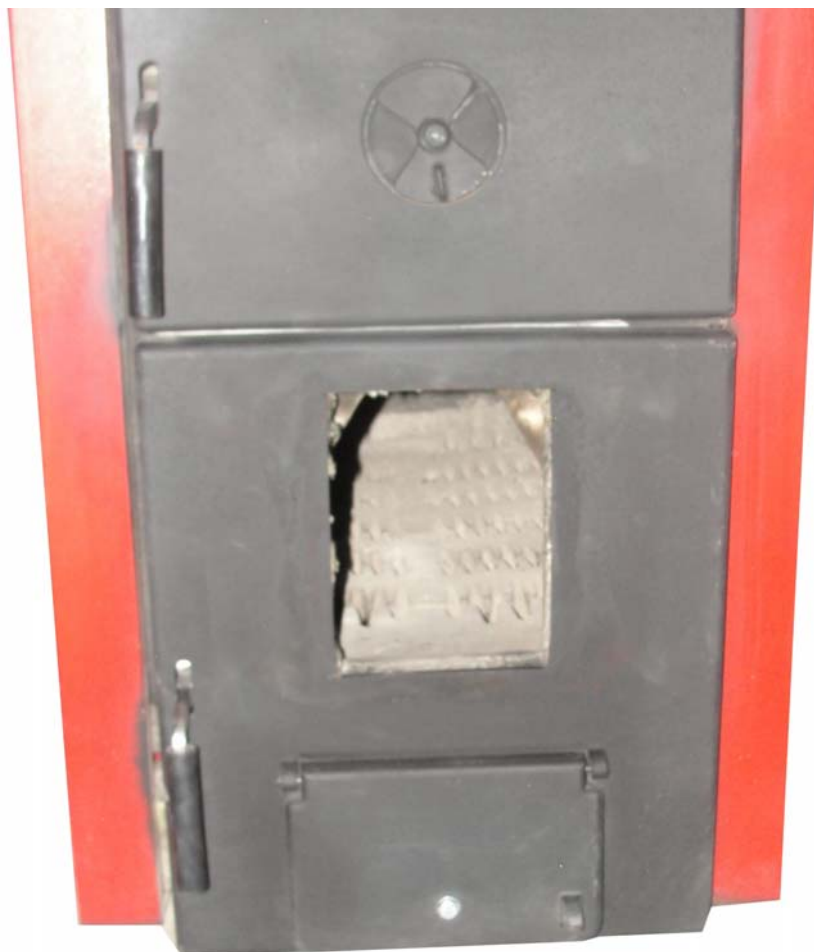
Фигура 1.4.4. Външен изглед на преработената врата за монтаж на пелетна горелка от серията “GP45” към водогрееен котел “VIADRUS U22”;
