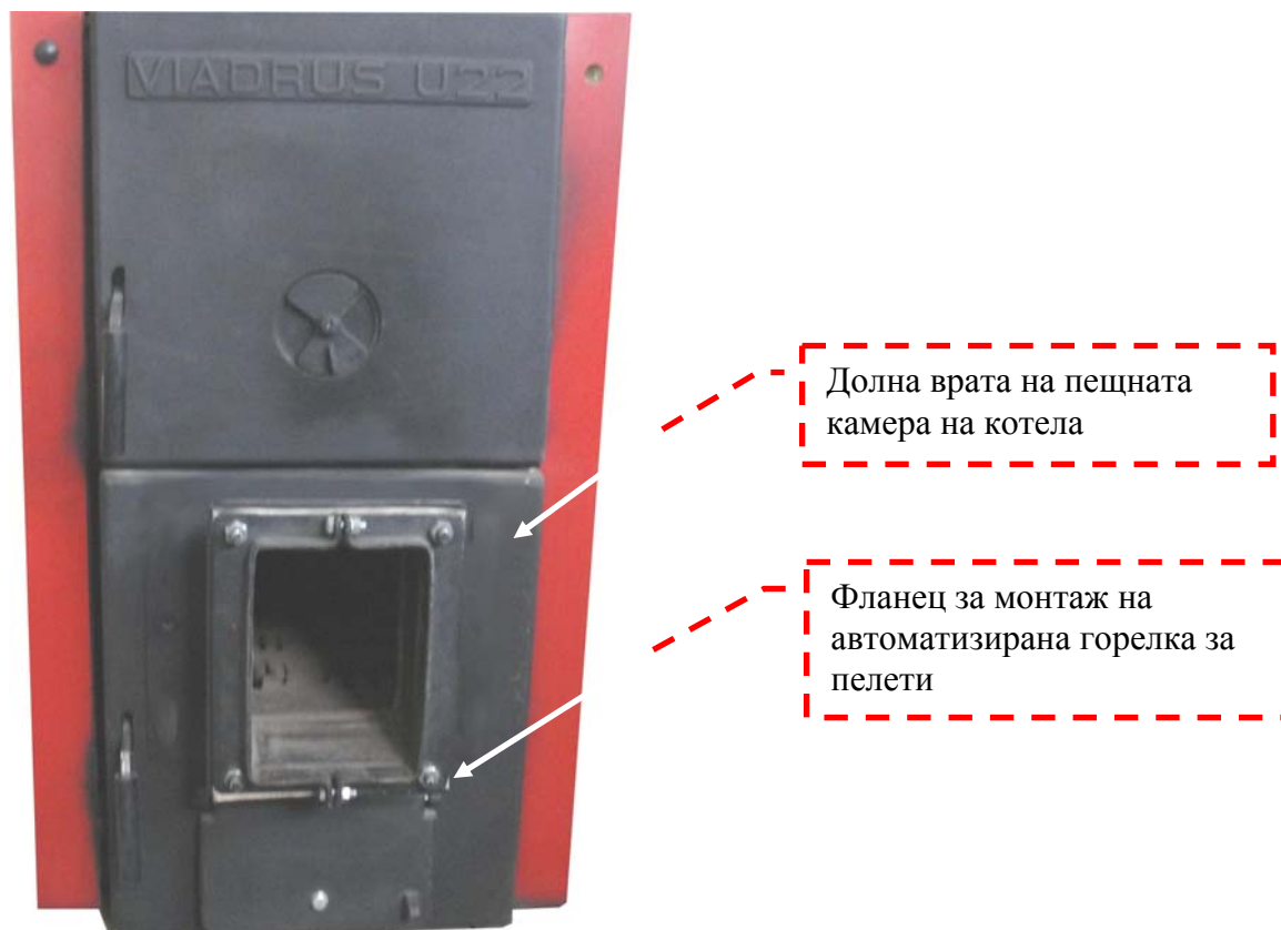
Фигура 1.4.11. Преработената долна врата на котела е монтирана на котелното тяло. На вратата е присъединен и фланеца за монтаж на автоматизираната горелка за пелети;
